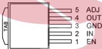
5-Pin TO-252 (D-Pak) Adjustable Voltage (D) MIC29302AWD
